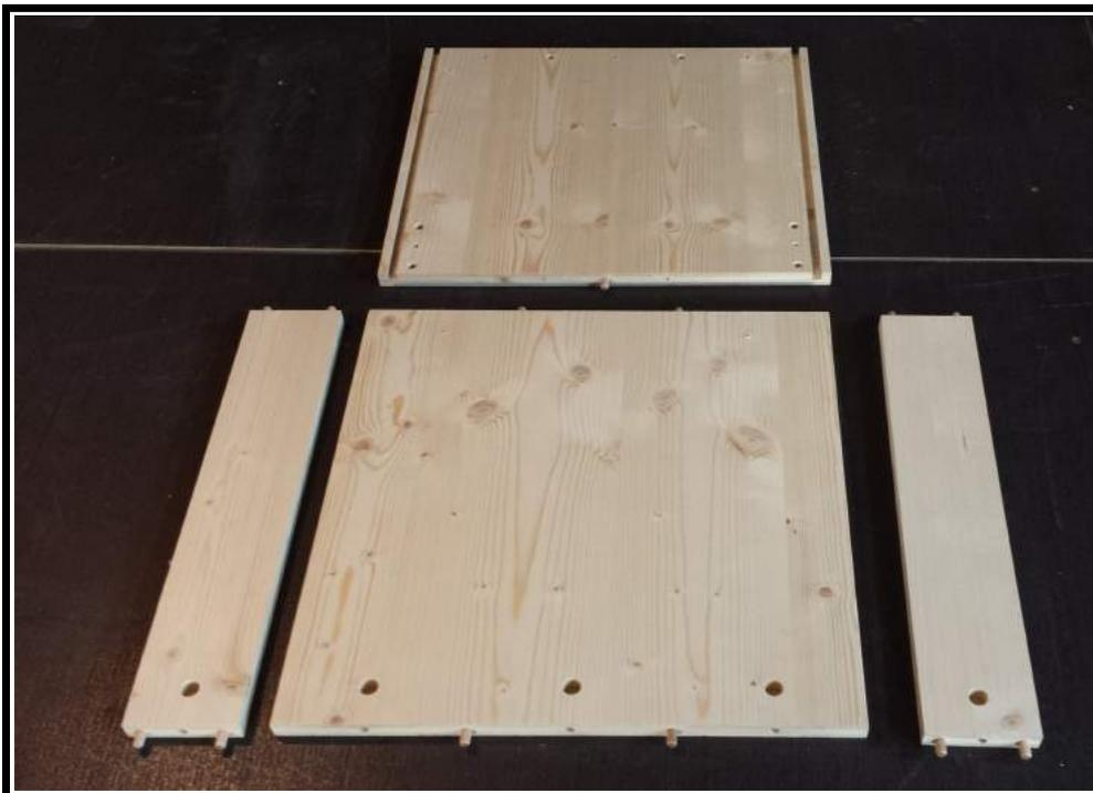
Die Dübel werden in die kantenseitigen Löcher eingeschlagen. Es gibt allerdings auch Löcher, die für die Minifix - Verbinder vorgesehen sind und in die keine Dübel gesteckt werden. Diese fünf Löcher erkennt man daran, dass sie zu einem jeweils größeren Loch (15 mm Durchmesser) in der Fläche führen. Dies ist im oberen Bild auch gut zu sehen.
